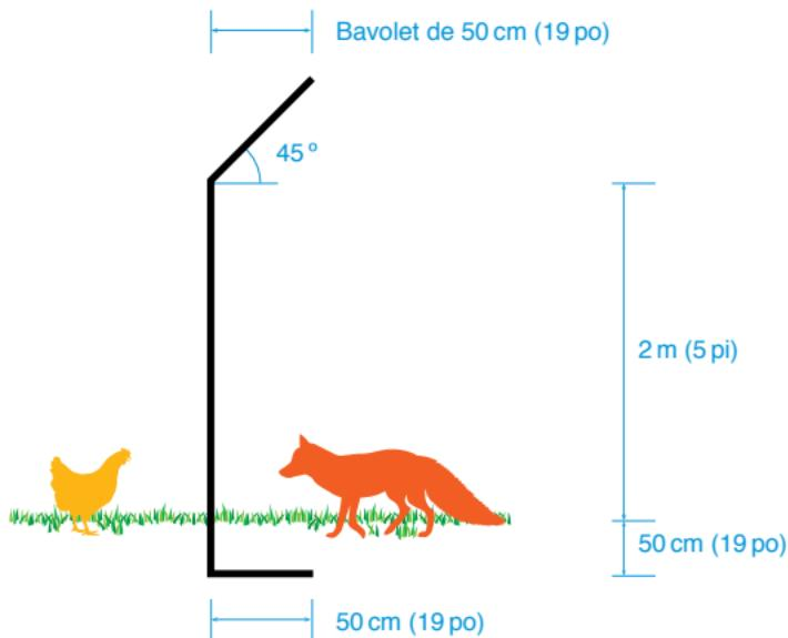
**Clôture à l'épreuve des renards :** Ce plan montre comment aménager une clôture non électrifiée pour empêcher les renards de pénétrer dans un poulailler. Une autre solution consisterait à enfouir le tablier à un angle de 45 degrés plutôt qu'à 90 degrés (voir l'illustration ci-dessus – pas à l'échelle). Il est également possible de daller le périmètre et faire passer le grillage en dessous. Le bavolet n'est pas nécessaire si le poulailler est sécurisé par un toit grillagé.
